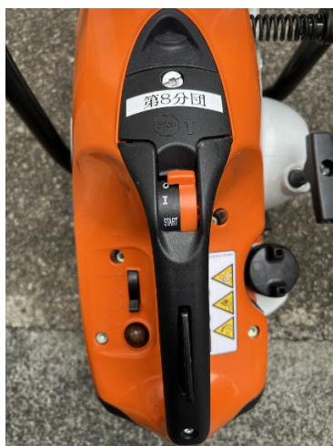
図 14. スタートスイッチ（停止状態）
