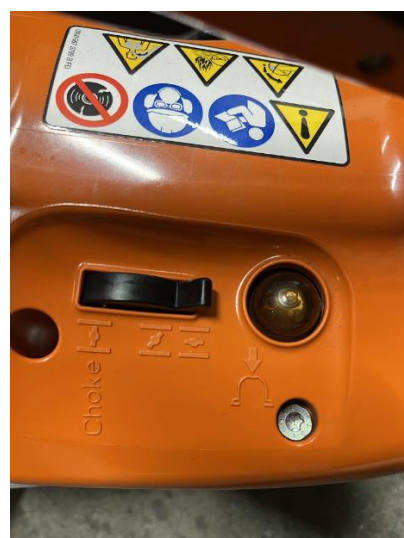
図 9. チョークスイッチ（チョーク OFF 状態）／プライマリーポンプ
