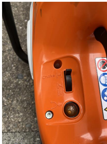
図 11. チョークスイッチ（チョーク OFF 状態）／プライマリーポンプ
